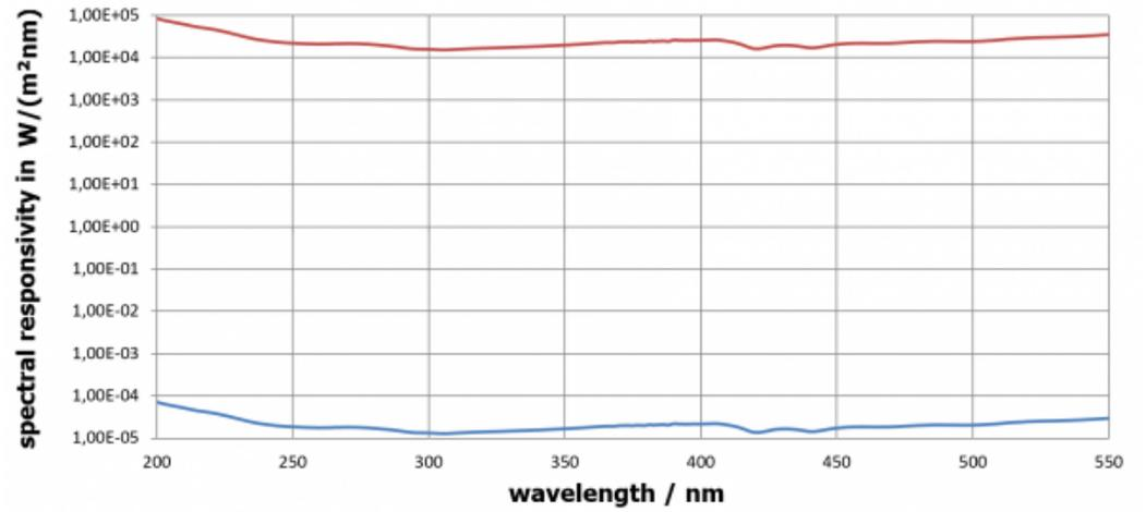
spektrale Empfindlichkeit  $W/nm$  (spektrale Strahlungsleistung) mit einer 80 mm Durchmesser Ulbrichtkugel:
