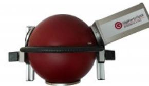
*Ulbrichtkugel: Direkte Montage des Messgerätes mit Zubehör*
